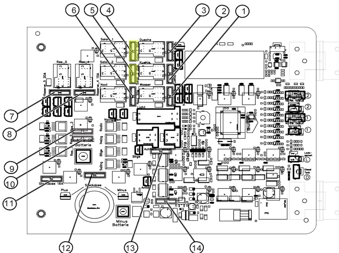
Les fusibles suivants (fusibles à fiche plate) sont montés à l'arrière du Panel 301 ; pour le remplacement, observez les valeurs nominales correctes des fusibles à fiche plate.
