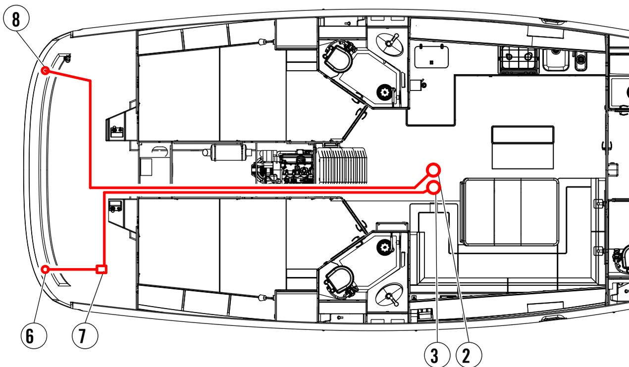
Cette illustration provient du plan du système d'eaux usées et ne comporte par conséquent que les composants des pompes de cale.
